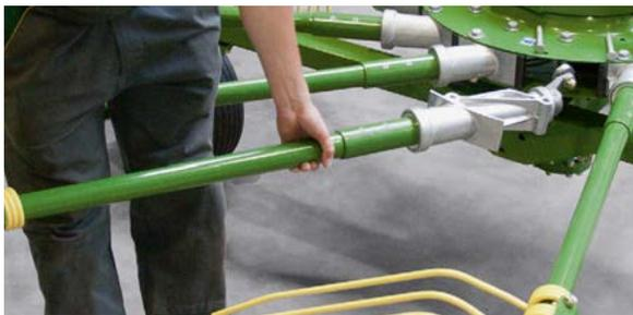
Hauptbestandteil des Zinkenarms ist das dickwandige Zinkenrohr. Dieses ist verschleißfrei und fest mit der Steuerrolle verbunden. Dadurch entsteht eine spielfreie Verbindung zum Zinken. So steigert der KRONE Swadro die Recharbeit und sorgt für optimale Zinkenführung.
